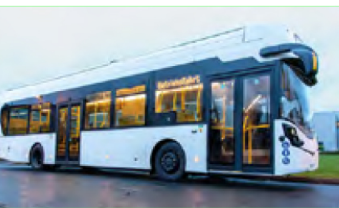
Der Kite Hydroliner von Wrightbus – hier ein Linksvleher für den kontinental-europäischen Markt – kann 90 Fahrgäste befördern und hat mit einer Tankfüllung einen Aktionsradius von bis zu 720 Kilometern.
