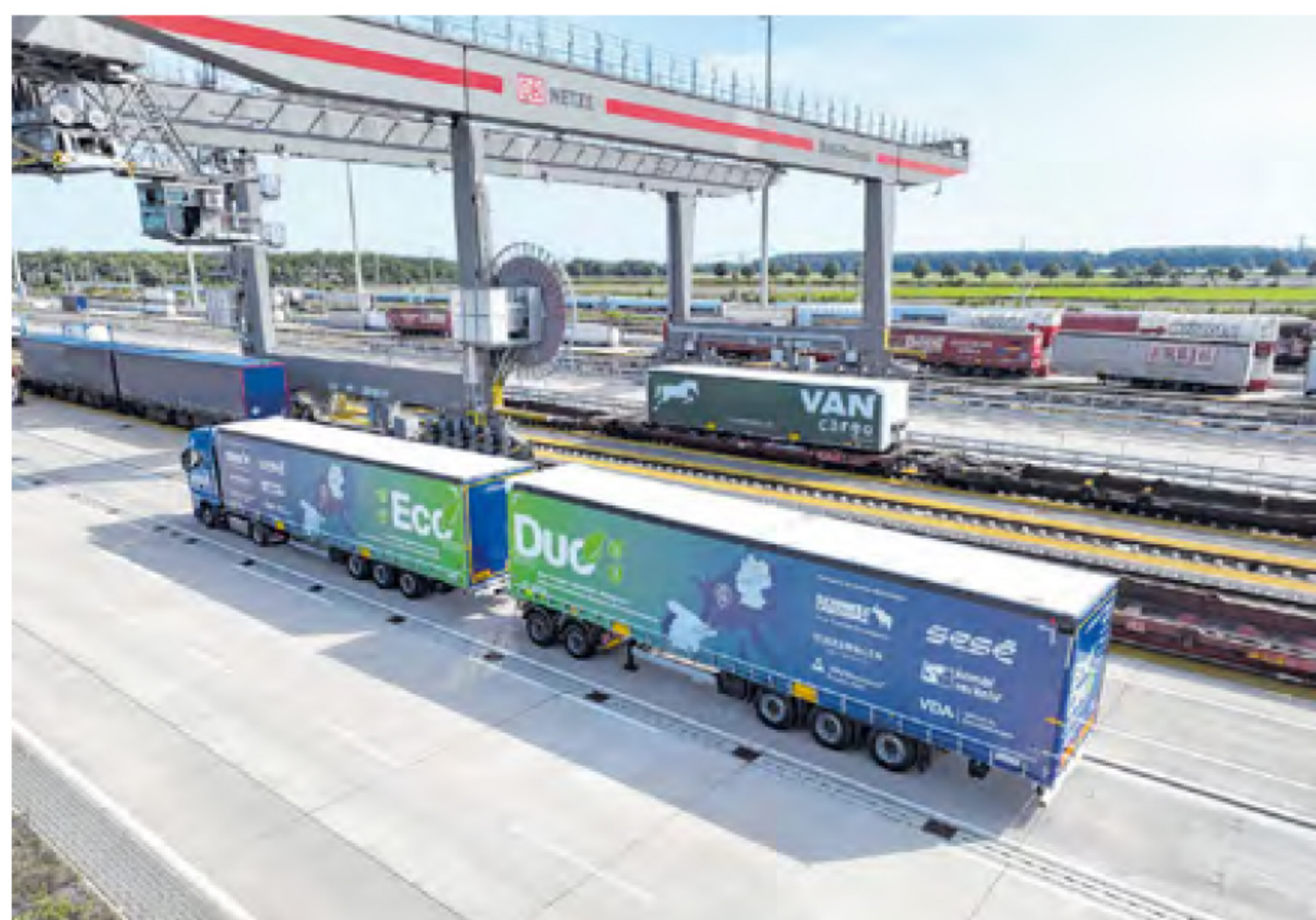
Lang-Lkw von Schmitz Cargobull: In einigen europäischen Ländern werden die Doppel-Sattelschlepper bereits im Regelbetrieb eingesetzt.
