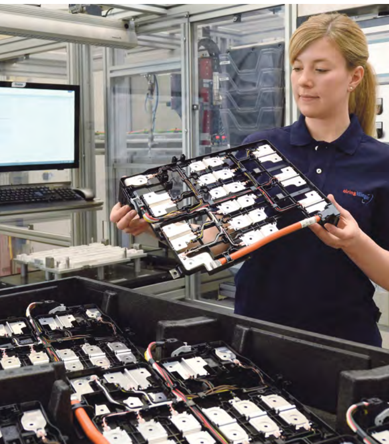
Abschließende Sichtprüfung bei der Produktion von Zellkontaktiersystemen für Lithium-Ionen-Batterien.
